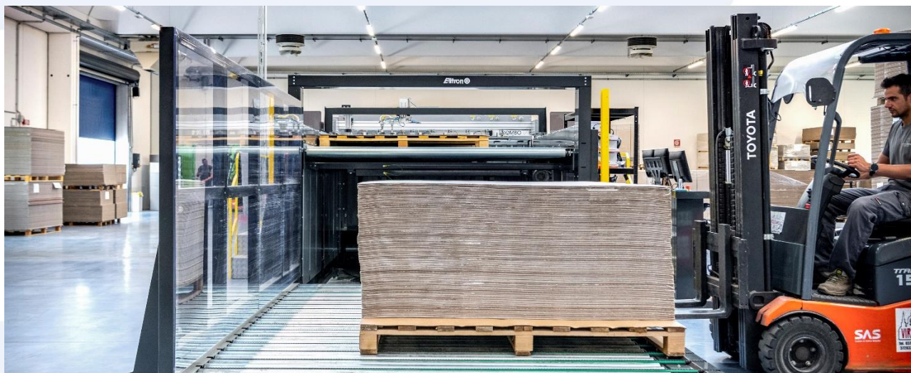
Caricamento su Kombo TAV di un pallet di cartone ondulato stampato
