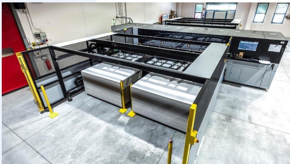
Durst P5 350 HS con i moduli di carico e scarico Automat
