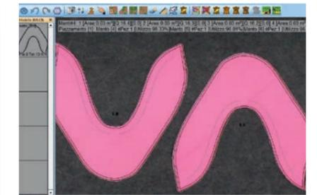
Software di riconoscimento ottico delle sagome piazzate sul piano di lavoro (sbozzi). Gli sbozzi, una volta lavorati vengono riposizionati sul piano di taglio e Recut provvede al piazzamento automatico su di essi per ritagliarne i pezzi netti.
