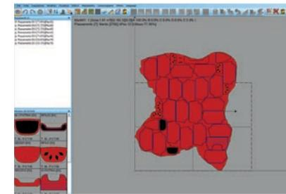
Massima rapidità di esecuzione e ottimizzazione nell'utilizzo dei materiali. Software di piazzamento automatico di sagome su pelle, con scansione del perimetro del materiale. L'intuitiva interfaccia grafica permette di gestire numerose operazioni: acquisizione immagine della pelle, individuazione difettosità, configurazione parametri di nesting. Elabora e archivia i piazzamenti e genera statistiche e report.
