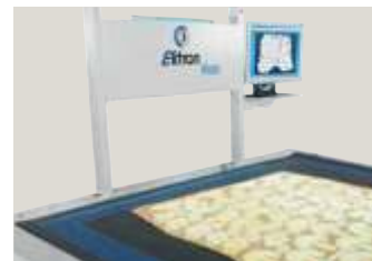
Elitron Visio, sistema per il piazzamento delle sagome fuori macchina
